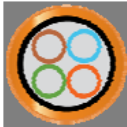
Εικόνα 9: Ενδεικτική τομή πολυσωλήνιου άμεσης ταφής τεσσάρων μικροσωληνίσκων
